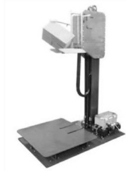
الشكل ج/٧ - أجهزة اختبار السقوط الحر ذات ذراع تارجح
