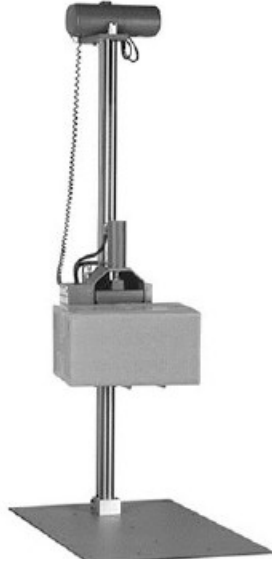
الشكل ج/٧ - أجهزة اختبار السقوط الحر ذات ذراع تارجح
