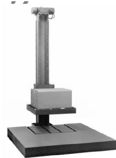
الشكل ج/٦ - أجهزة اختبار السقوط الحر ذات عربة سقوط
