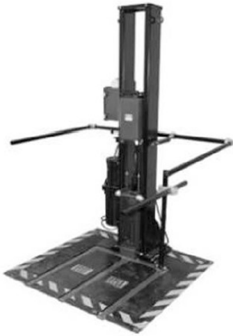
الشكل ج/٦ - أجهزة اختبار السقوط الحر ذات عربة سقوط
