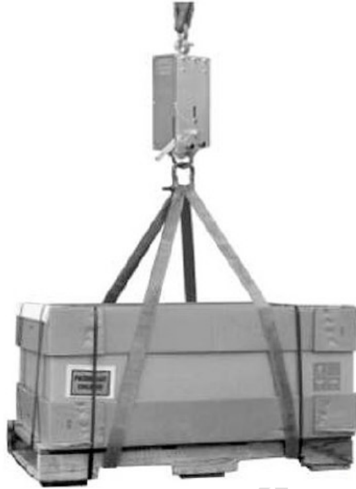
الشكل ج/٥ - جهاز اختبار السقوط الحر بالتحريك السريع
